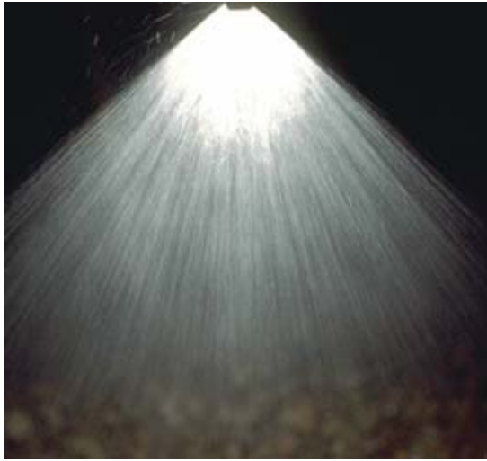
Flat fan nozzle pattern
