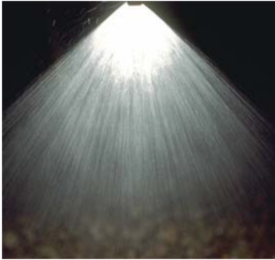
Flat fan nozzle pattern
